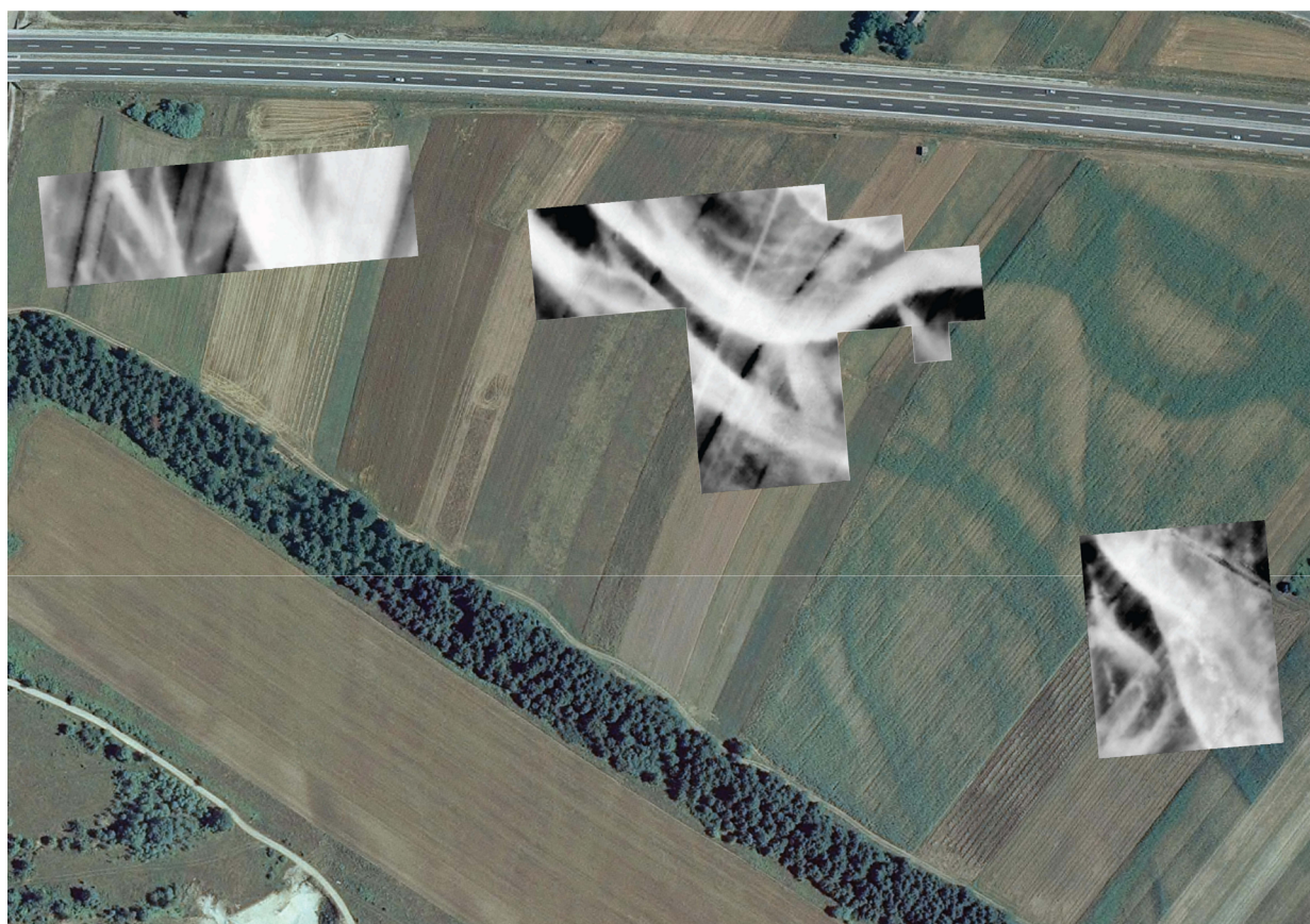
Slika 7 Geofizikalne raziskave, ekstenzivno. Primer rezultatov upornostne metode na Krškem polju (arhiv ZVKDS, CPA).
