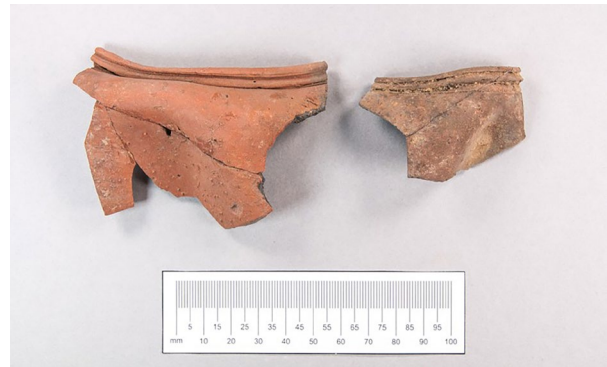
Slika 77 Deformirana odlomka čaš gubanke (ČF 1) zaradi neprimerne temperature žganja iz polnila peč 3/1985. Na ostenju imata žrnast premaz. Nista izrisana (foto S. Pukšič).
