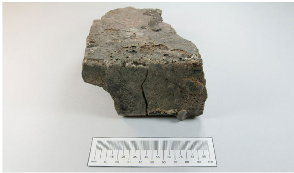
Slika 33 Odlomek opeke, ki je bil del konstrukcije peči in je zaradi vročine temno sive barve, napokana in nataljena (foto S. Pukšič).
