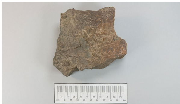
Slika 35 Odlomek opeke, ki je bil del konstrukcije peči. Na desnem delu je vidno, da je bil premazan z glino. Zaradi vročine je napokan in temno sive barve (foto S. Pukšič).
