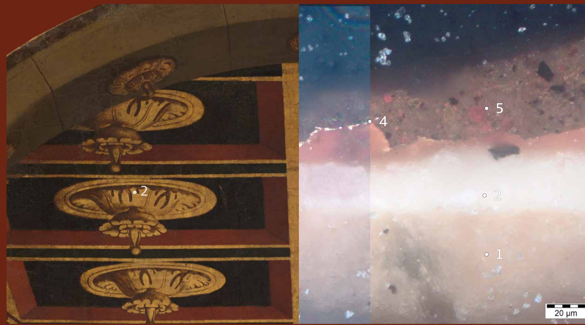
Stratigrafija mikrotokacije vzorca VCM 2: 1 – klejno-kredna podloga, 2 – svinčeva bela, 3 – svinčeva bela, goethit, hematit, 4 – zlati lističi, 5 – hematit, cinober, ogljikova črna.
