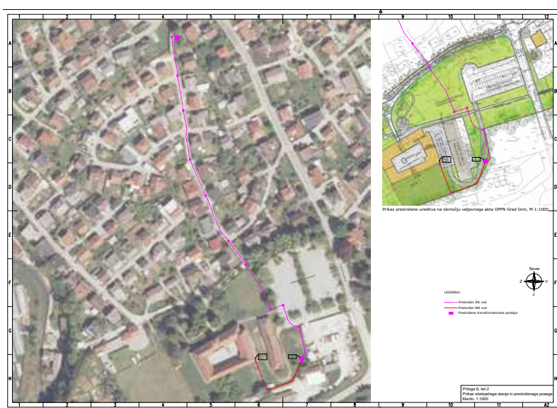
Slika 2: Označena trasa električnih vodov za postavitev transformatorske postaje pri gradu Grm (Foto: arhiv ZVKDS OE NM)
