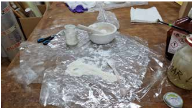
Slika 3: Priprava smole damar za izdelavo laka (Foto: Zdenka Salmič Pungerčar)
