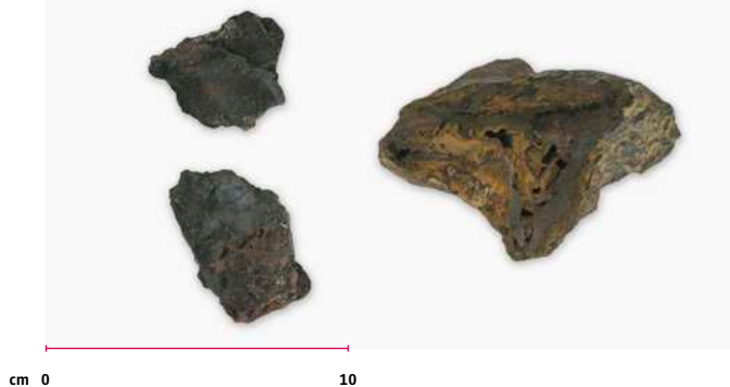
84 Zunanja površina iste limonitne geode: nepražena (levo) in pražena (desno).
