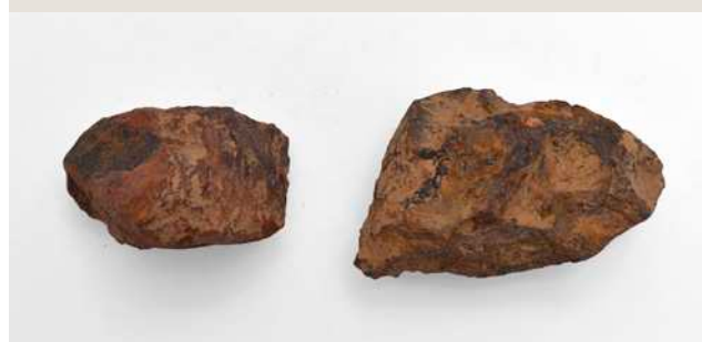
82 Vzorca rude: (levo) rdečkasta hematitna površina (V 8), (desno) površina in prelom brez hematitne površine (V 9).
