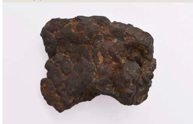
73 Zunanja površina tekoče žilndre, vzorec V 2.
