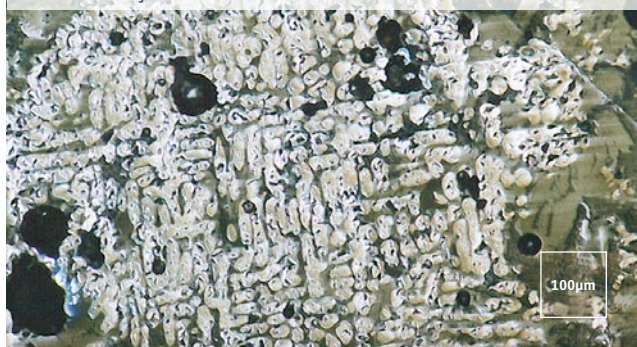
51 TR3. Skupek kroglic wustita v silikatni matriki, ki jo sestavlja predvsem letvasti fayalit.
