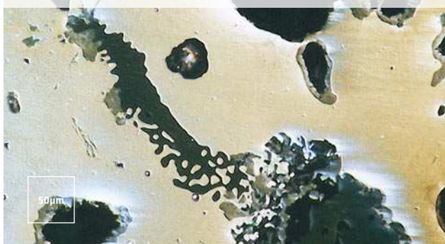
55 TR3. Podroben pogled na obrobje istega kovinskega fragmenta po razjedanju z nitalom. Pokažejo se dekarbonizirana feritska struktura in kosci rezidualne žlindre.
