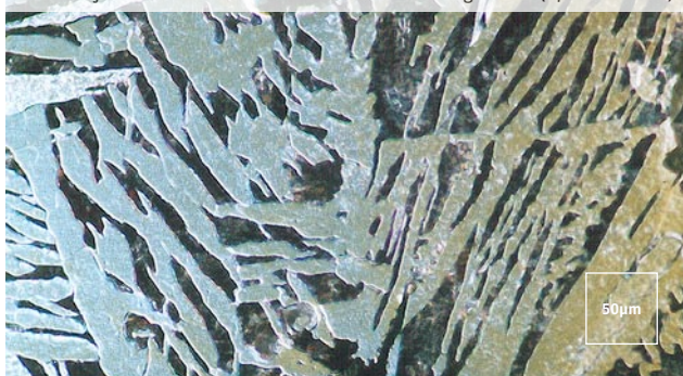
56 TR3. Podroben pogled na središče istega kovinskega fragmenta po razjedanju z nitalom. Pokaže se struktura koničastega ferita (0,4 odstotka C).
