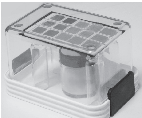
Slika 2. Komora, v kateri vzdržujejo konstantno relativno vlažnost. Nasičena raztopina soli je v steklenem kozarcu, pokritem z membrano iz GORE-TEX®.a. Vzorci na PTFE ploščicah so nameščeni nad kozarcem, med temnimi kontrolnimi vzorci in svetlobi izpostavljenimi vzorci so neprozorne črne kartice.
