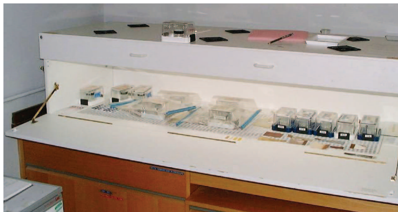
Slika 1. Svetlobna komora, uporabljena za poskuse pri bledenju. V njej se vzdržuje povprečna temperatura okoli 25° C; dno je perforirano, da omogoča pretok zraka, ventilatorji v pokrovu odvajajo toploto, ki jo ustvarjajo fluorescenčne cevi, iz naprave. Na desni je vidnih pet komor, v katerih vzdržujejo različne stopnje relativne vlažnosti.
