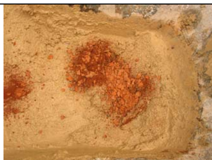
Dodatek drobljene opeke v malto poveča trdnost
