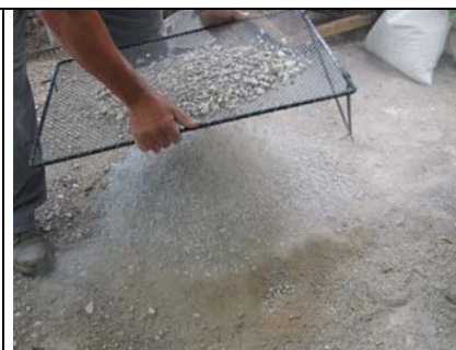
Sejanje peska na zeleno granulacijo
