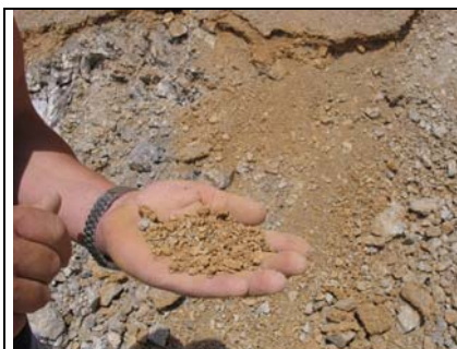
Barva peska je pomembna pri pripravi ustrezne malte
