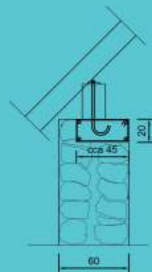
Izvedba AB venca ob kapu, s sidranjem kapne lege • Vir: Arhiv Mojca Jarc Simonič
