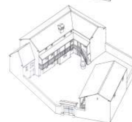
Shematična rekonstrukcija razvoja značilnih prostorskih in oblikovalskih elementov kraške hiše. Vir: Ljubo Lah, Prenova stavbne dediščine na podeželju KRAS, Tiskarna Novo Mesto 1994
