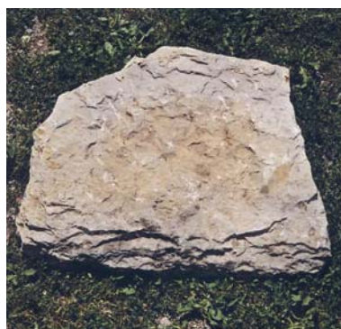
Slika 20 Tipičen primerek srednje velike skrole iz kompaktnega tenko plastovitega povirskega apnenca z nekdanje skrlnate strehe Toninovih v Povirju.
