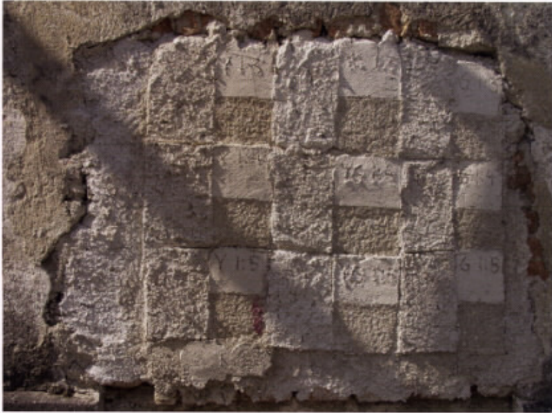
Primer priprave vzorcev ometa z različnim peskom in v različnih razmerjih, H. Weissenbach, cerkev sv. Luke, Prapreče pri Lukovici, 2003
